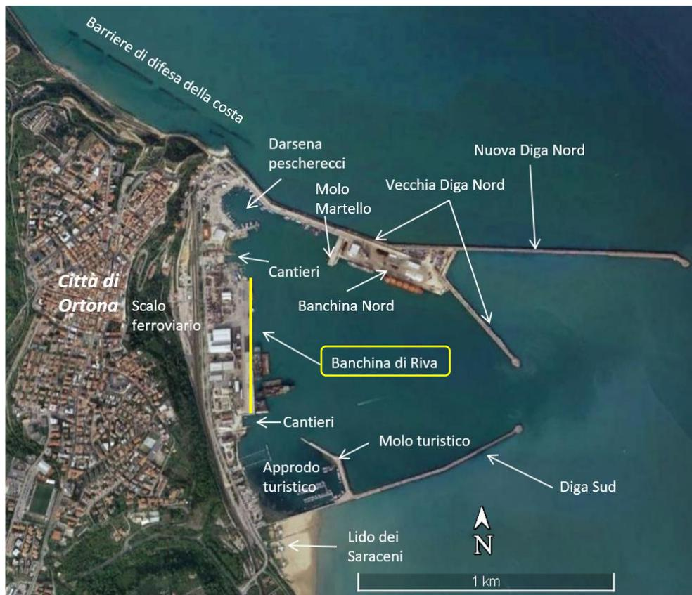
**Figura 2-4 Inquadramento generale del Porto di Ortona e delle sue principali strutture marittime**
