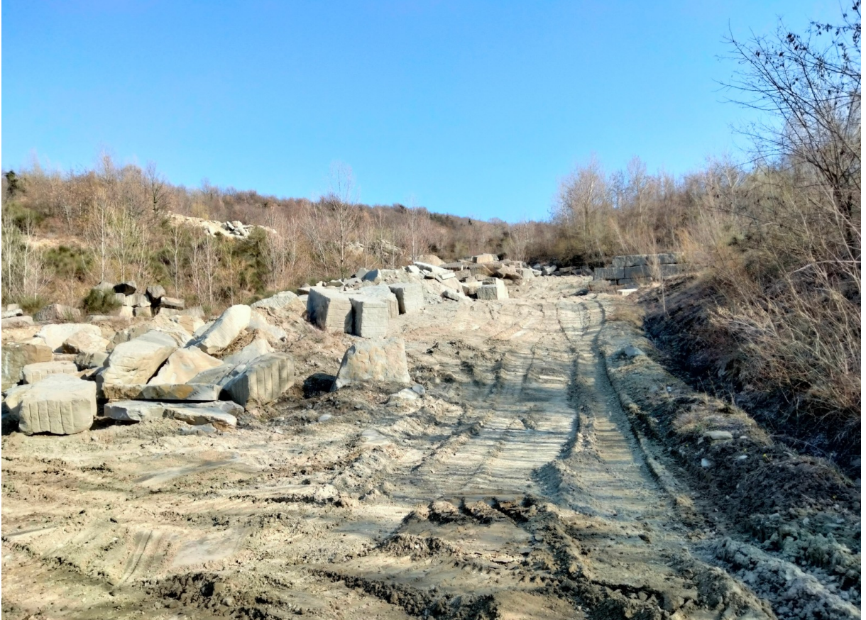
Foto 9 – La foto mostra la porzione centrale della cava, qui non è prevista escavazione ma solo movimentazione e stoccaggio dei blocchi in attesa di essere segati all’impianto monolama posto poco più a valle.
