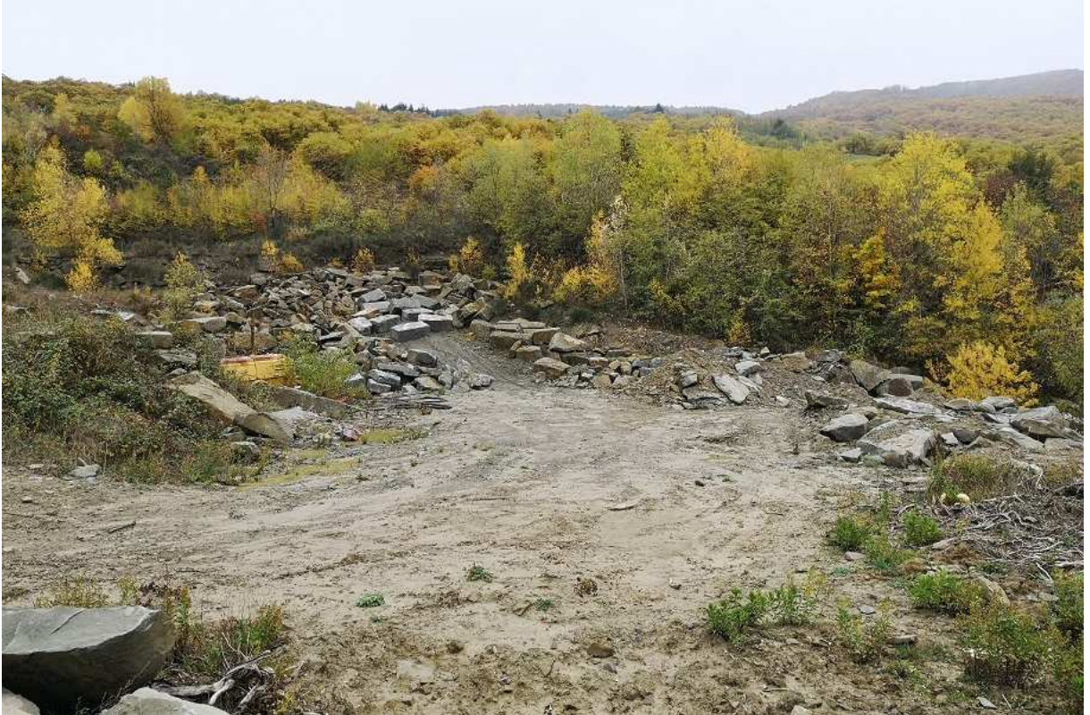
Foto 7 – La foto mostra la porzione centrale e superiore dell'area di cava, sullo sfondo la zona esaurita in fase di riempimento, in primo piano il terrapieno che sarà movimentato ed andrà a riempire la zona esaurita a monte; il punto in cui è stata scattata la foto, che si trova al confine dell'area in ampliamento, verrà progressivamente interessato dall'escavazione. La fascia alberata sullo sfondo coincide con il limite di intervento e non sarà intaccata.
