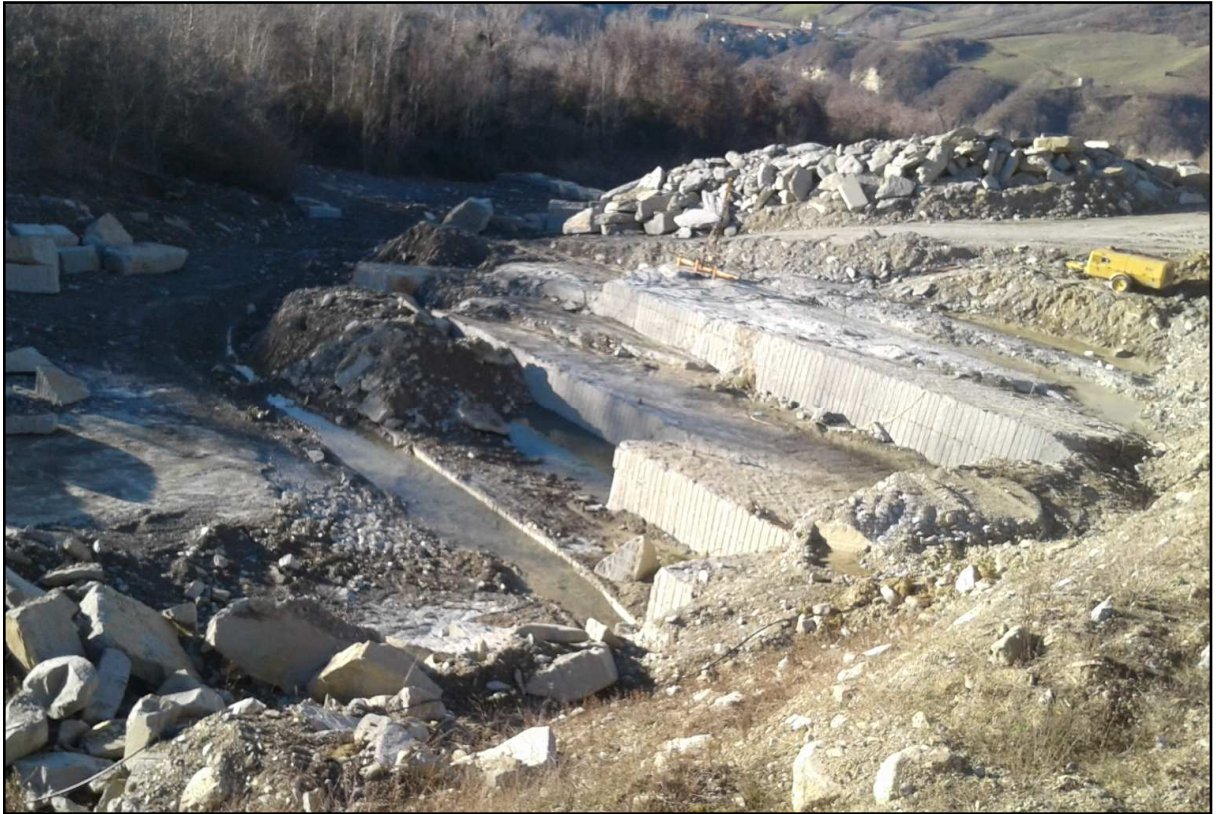
Foto 3 – Visuale interna della porzione di cava attiva cava. Si osservano i filari arenacei oggetto di estrazione ed il fronte di scavo molto poco sviluppato in altezza.
